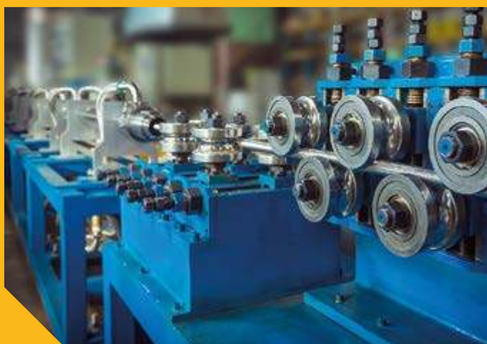
Линия охлаждения гофрированной трубы Stahlmann после отжига
